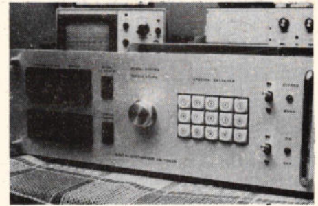
Een blik op het front van de gemonteerde FM-ontvanger. Duidelijk zijn hier de bedienings-toetsen te zien waarmee 15 verschillende frequenties in het geheugen kunnen worden gezet.
