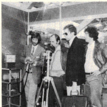
Afb. 1. Het biofocus systeem bij een demonstratie. Boven het camera-objectief bevindt zich de elektromotor die het objectief draait. Het stuurgeedeelte is in een aparte kast, onder het meetinstrument ondergebracht.
