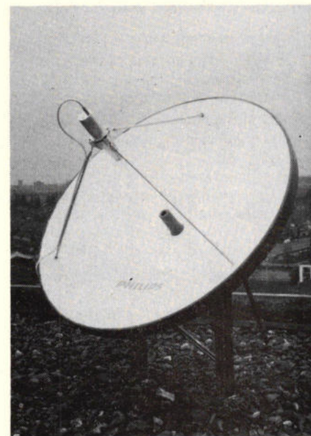
Afb. 3. Paraboolreflector met in het brandpunt de ontvangantenne. Direct achter de antenne is de „outdoor unit“ bevestigd.
