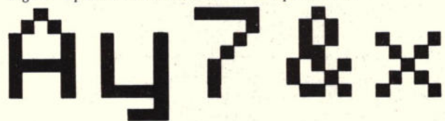
Fig. 6. Opbouw van tekens in een 5 \times 9 puntmatrix.
